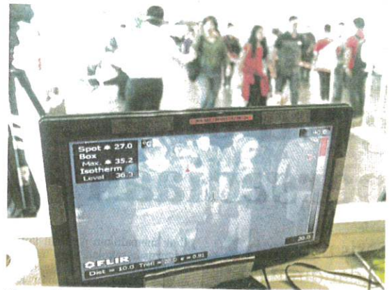
Kamera thermal mengesan suhu badan di Pusat Pemantauan Saringan Suhu Badan berfungsi 24 jam di Lapangan Terbang Antarabangsa Kuala Lumpur 2 (klia2). (Foto Mohd Fadli Hamzah/BH)
